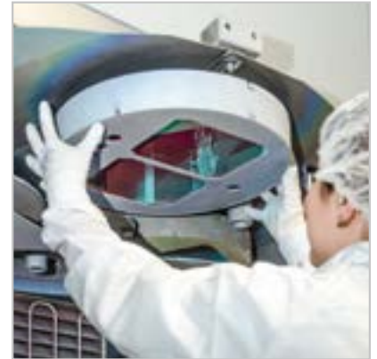
Einbringen der Substrate in ein PIAD-Beschichtungsanlage.
