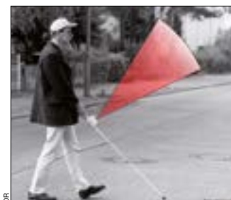
Figure 1 : aide à l'orientation – canne blanche à laser destinée aux déficients visuels.
