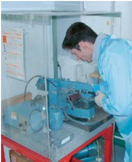
Bild 2: Herstellen und Bearbeiten von Bleiselenid-Lasersubstraten
