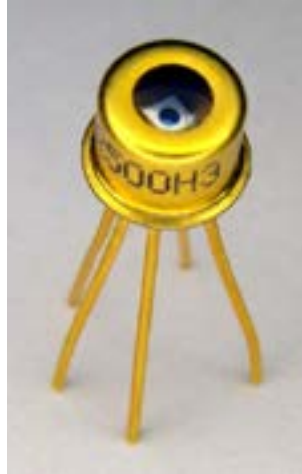
3: AC-gekoppelter APD-Receiver in einem 5-PIN TO-46-Gehäuse
