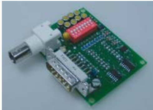
Bild 2. Die Ansteuerplatine LC-V8 der Laser Components ermöglicht die individuelle Ansteuerung von acht Single Mode VCSEL
