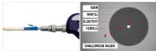
Abbildung 6: Prüfung des Patchkabels mit dem Videomikroskop
