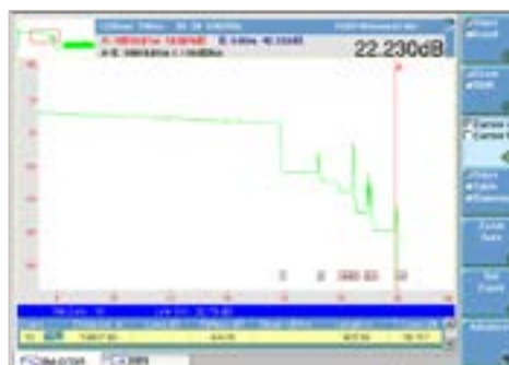
Abbildung 16: Test eines Netzwerks mit kaskadierten Splittlern ab dem OLT ohne Vorlaufaser
