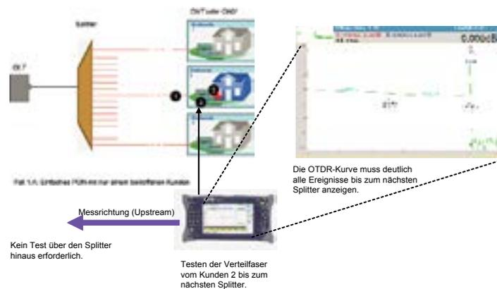
Abbildung 10: Die OTDR-Messung wird in Upstream-Richtung ausgeführt. Die Kurve ist nur bis zum Splitter von Bedeutung.
