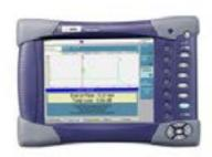
$Abbildung\ 14: Empfohlene\ Messtechnik:\ optischer\ Handtester\ der\ Produktfamilie\ Smart\ Class\ oder\ die\ mit\ einem\ OTDR-Modul\ ausgestattete\ Plattform\ T-BERD/MTS-4000\ bzw.\ T-BERD/MTS-6000.$
