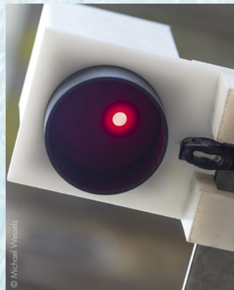
A quai (gauche) les lasers d'auto-niveau (milieu) et détecteurs de précision (droite) garantissent le positionnement précis au millimètre près de modules pesants plusieurs tonnes.
