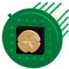
Bild 2: Detailaufbau eines Quantenkaskadenlaserchips in einem TO-8-Gehäuse
