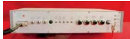
Bild 5: GENPULSE, Strom- und Temperatursteuerung für gepulste Quantenkaskadenlaser bei Raumtemperatur
