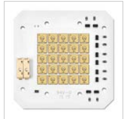
Ein 5x5-LED-Array von Bolb liefert eine Leistung bis zu 2,5W.
