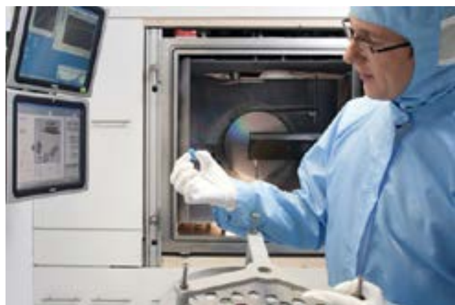
6 Das Beschichten von Laseroptiken beherrscht Laser Components mit einer eigenen IBS-Anlage.
