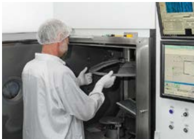
Um die Restreflexion an den Übergangflächen zu minimieren, werden die Faserenden von Lichtleitern im Vakuum mit dielektrischen Schichten bedampft. Dadurch kann die Restreflexion von 4 auf unter 0,5 Prozent reduziert werden.
