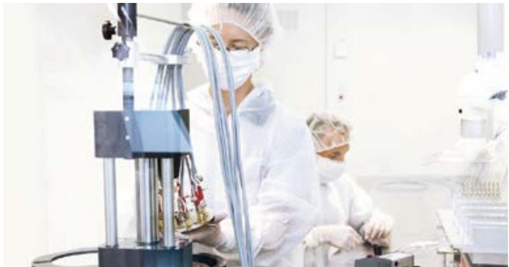
Der Polierprozess der Glasfaser-Enden erfolgt mit feinen Oxiden. Im Bild wird gerade eine Poliermaschine für den Betrieb vorbereitet. In die Vorrichtung rechts im Bild werden die frisch verklebten Stecker eingesetzt und unter gezielter Wärmeeinbringung ausgehärtet.
