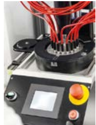
Eine spezielle Aufnahmevorrichtung gewährleistet beim Polieren die exakte Ausrichtung der Stecker zur Polierebene.
