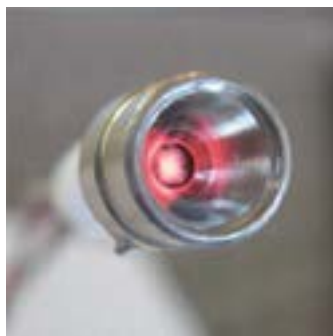
Bild 2: Infrarotstrahler der Bauserie MIRL in MEMS-Mischtechnologie. Die Aufnahme entstand bei laufendem Betrieb. Der Chip ist in ein TO-Gehäuse mit zusätzlichem Reflektor integriert
