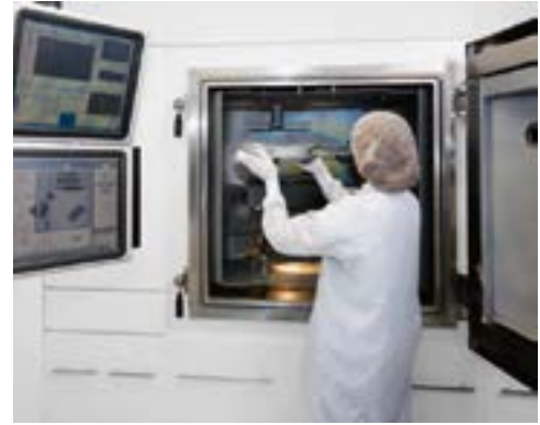
Die Anlagen beschichten automatisch unter Einsatz eines In-line-Messverfahrens, links auf den Monitoren sind Soll- und Ist-Kurven zu sehen.
