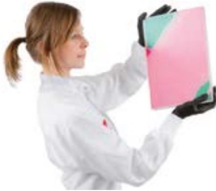
Die Spiegelsubstrate sind bis zu 60 mm dick. Im Vergleich zu einem Menschen wird die Größe moderner Spiegeloptiken deutlich.
