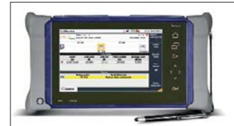
Bild 6: Einfache Benutzeroberfläche am Beispiel des Viavi MTS-4000 mit dem Smart Link Mapper (SLM) (Foto: Viavi)
