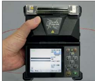
Bild 3: Kompaktes, kostengünstiges FFTx-Spleißgerät: das Fitel Ninja (Foto: Fitel Furukawa)
