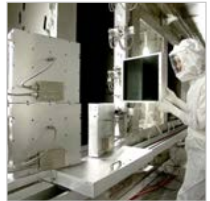
Abbildung 1: Ein Techniker testet vier große Kalorimeter von Gentec-EO in der National Ignition Facility. (Quelle: Lawrence Livermore National Laboratory)
