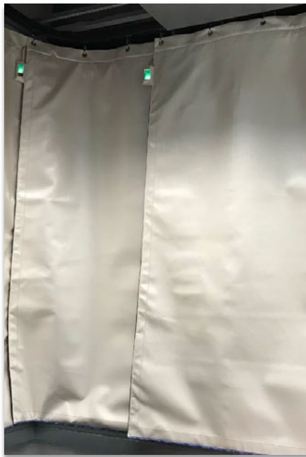
Aktive Laserschutz-Vorhänge in Reihe geschaltet
