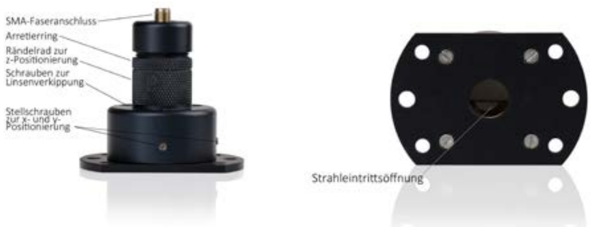
Abbildung 4: Faserkopplung Aufbau und Funktion
