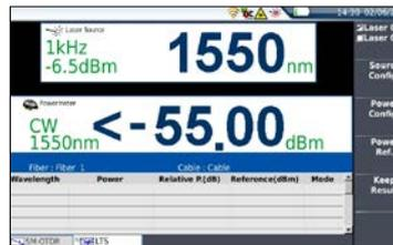
Integrierter Leistungspegelmesser und Laserquelle
