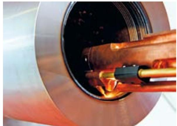
**Bild 2:** Ein Laserstrahl verbindet das Beschichtungspulver mit der Rohrinne
