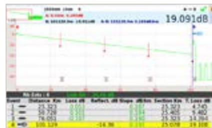
Grafische Darstellung einer Glasfaserstrecke, auch als OTDR-Kurve bezeichnet
