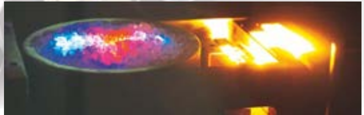
Bild 1: Bei einer Elektronenstrahl-Verdampfungsquelle erzeugt ein Filament (rechts) einen Elektronenstrahl, der durch Magnetfelder in den mit Beschichtungsmaterial gefüllten Tiegel gelenkt wird
