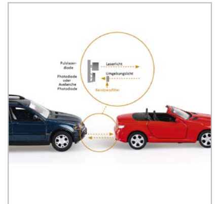
Abbildung 2: Abstands- und Relativgeschwindigkeitsmessung im Automobilbereich
