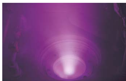
Bild 2: Mittels ECR (Elektron-Zyklotron-Resonanz) angeregte Ionenquelle zur ionenunterstützten Beschichtung
