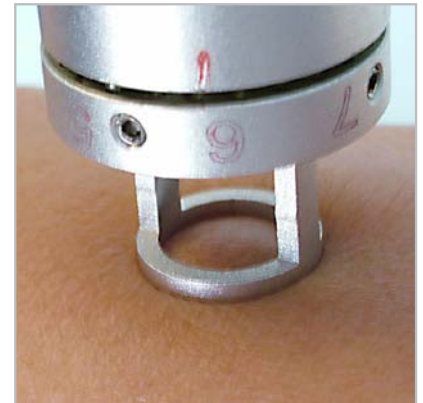
Bild 5: Handgerät zur minimalinvasiven Hautbehandlung mittels Laser
