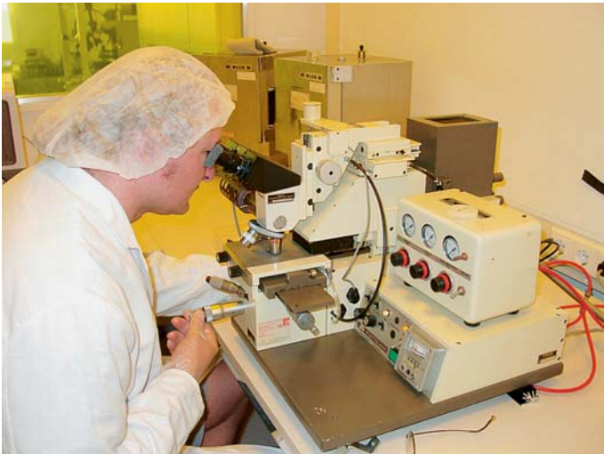
Bild 4a: Fotolithografie der IV-VI-Laserdioden
