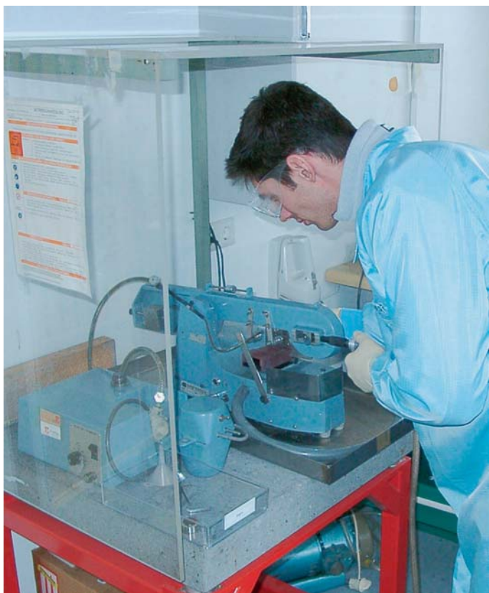
Bild 2: Herstellen und Bearbeiten von Bleiselenid-Lasersubstraten
