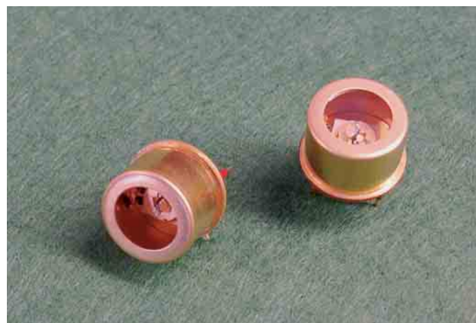
Bild 1: Quantenkaskadenlaser mit integriertem Peltier-Element und Temperatursensor, aufgebaut im TO-8-Standardgehäuse
