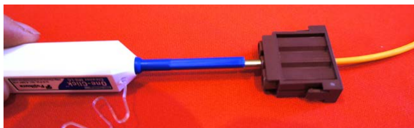
Oben: Nassreinigung mit Stäbchen (blau) Unten: danach Trockenreinigung mit OneClick
