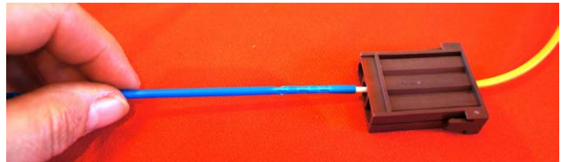
Zweimal reinigen: erst feuchte Seite, dann trockene Seite
