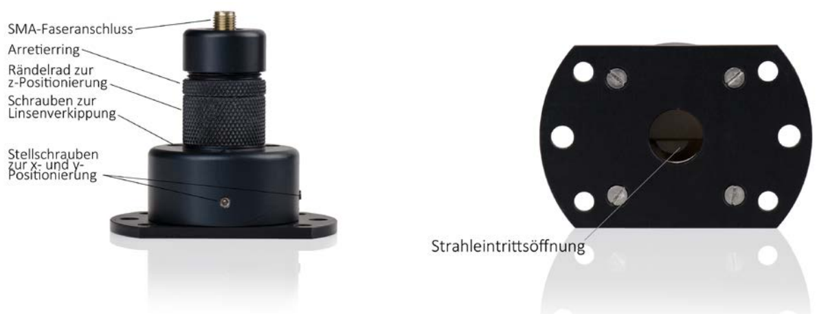
Abbildung 4: Faserkopplung Aufbau und Funktion
