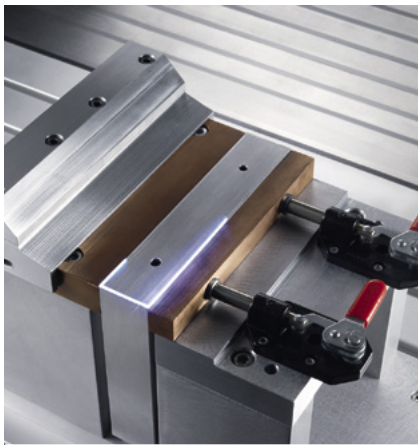
Laserschweißen eines Batteriegehäuses für eine einzelne Zelle in einem Batterieblock für Elektroautomobile. (Quelle: TRUMPF)
