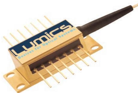
de leurs diodes lasers avec comme résultat des lasers couplés sur fibres ayant une densité de puissance élevée et une excellente efficacité de conversion.
