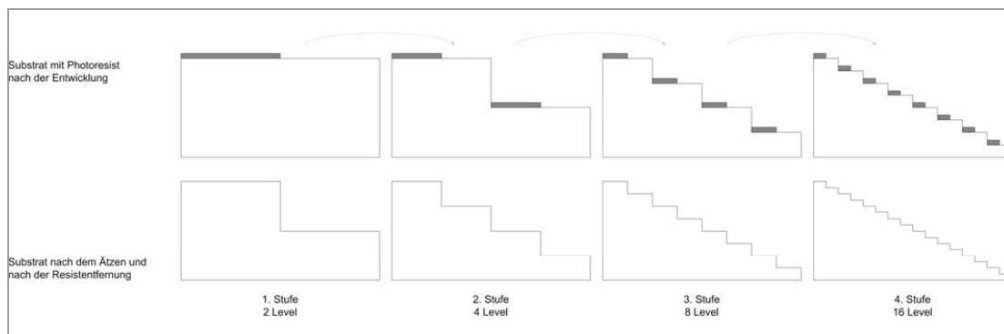
Abb. 6: Werden die Prozessschritte zur Erstellung eines DOEs mehrfach wiederholt, so werden die Stufen, die in das DOE geätzt werden immer kleiner, das Ergebnis damit immer genauer. Das Ergebnis der Stufenerhöhung sehen Sie deutlich in der Abb. 7.
